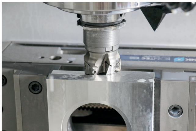
**5** Der Drehtisch EA-520.L-M1 passt hinsichtlich Antriebsleistung, Klemmkraft und Präzision ideal zur Werkzeugmaschine. Er lässt auch schwere Bearbeitungen zu
