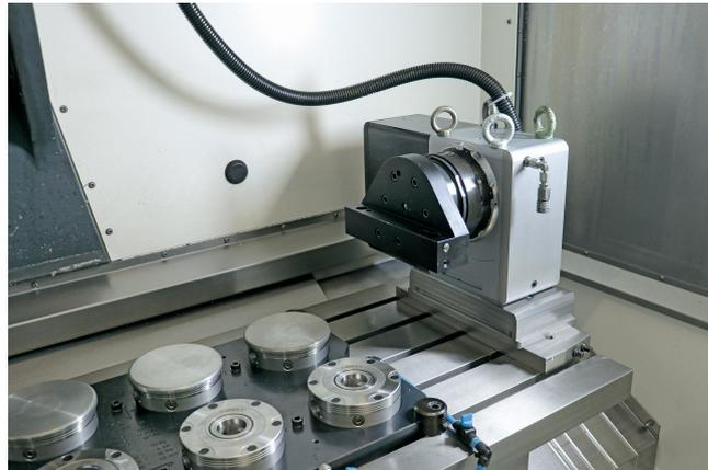
**4** Mit 20 kN Einzugkraft eignet sich der Gredoc-Nullpunktspanner sehr gut für die Spindel des Drehtisches – hier mit gespannter Adapterwange für die RotoFix-Spannbrücke. Ein schneller Wechsel zum Dreibackenspannfutter ist sichergestellt (© pL Lehmann)
