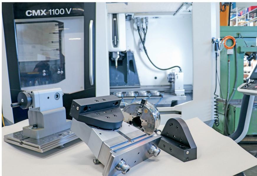
1 Ein CNC-Drehtisch EA520 von pL Lehmann mit vielfältigem Zubehör ergänzt bei AITech das neue 3-Achs-Bohrfräszentrum DMG Mori CMX 1100V. Im Vordergrund der verfahrbare Reitstock LongFlex, die Adapterwange für die Spannbrücke, deren Gegenlager und das via Gredoc-Nullpunktspannsystem montierbare Dreibackenfutter (© pL Lehmann)
